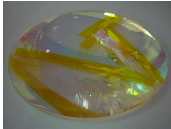
写真:VLTの面分光器SPIFFI(SINFONIの分光器部分)の直径220mmのBaF 2 レンズ。冷却中に割れた。 http://www.mpe.mpg.de/SPIFFI/
